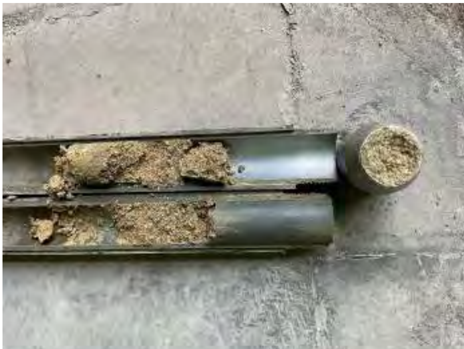
Fotografia nº 7. Sondeig S2. SPT a 7,0 m.
