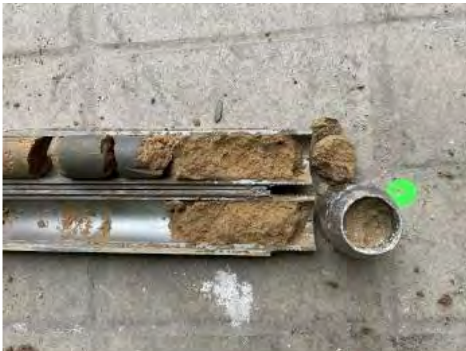
Fotografia nº 3. Sondeig S1. SPT a 4,4 m.
