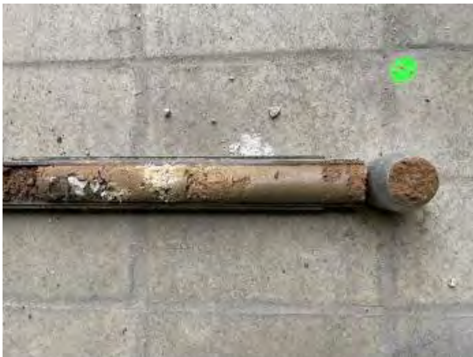
Fotografia nº 2. Sondeig S1. SPT a 1,0 m.
