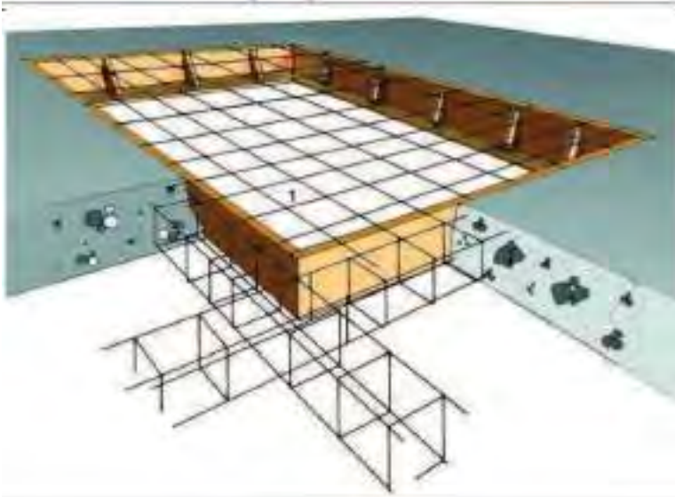
1. Malla electrosoldada en capa superior.
