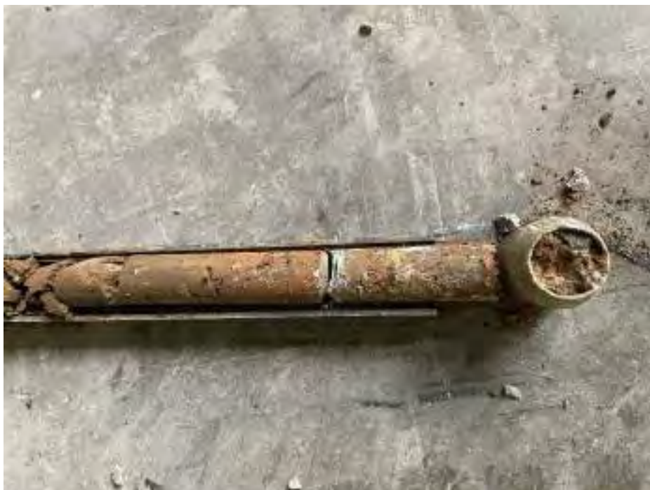
Fotografia nº 6. Sondeig S2. SPT a 4,5 m.
