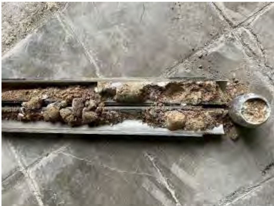
Fotografia nº 5. Sondeig S2. SPT a 3,0 m.
