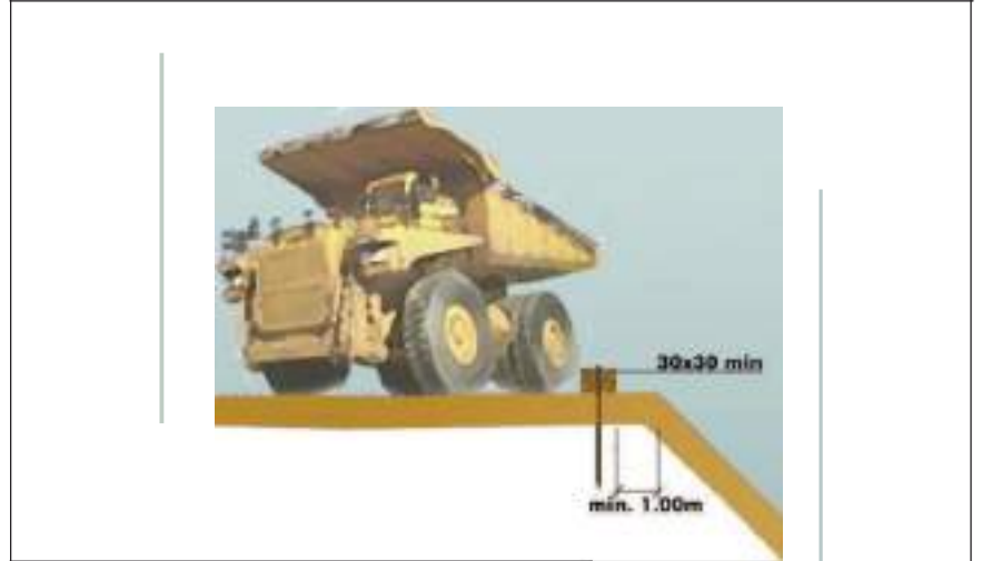
Esquema límit retrocés en vessament de terres variable segons el tipus de terreny
