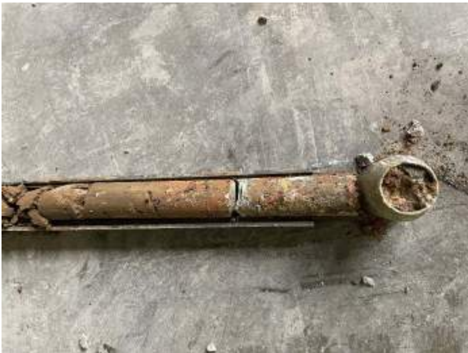
Fotografia nº 6. Sondeig S2. SPT a 4,5 m.
