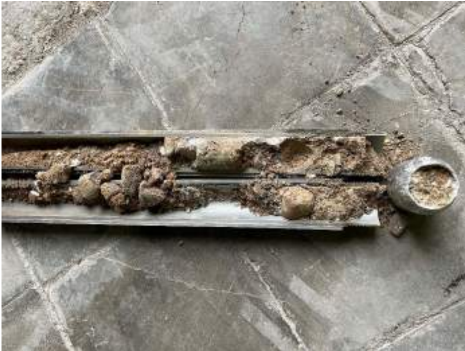
Fotografia nº 5. Sondeig S2. SPT a 3,0 m.
