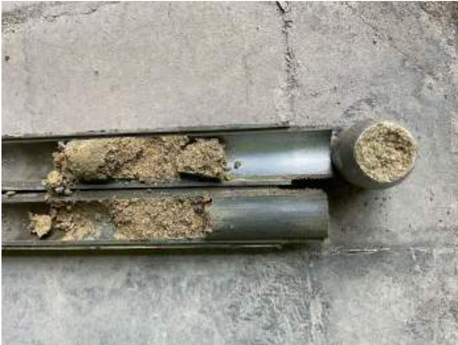
Fotografia nº 7. Sondeig S2. SPT a 7,0 m.
