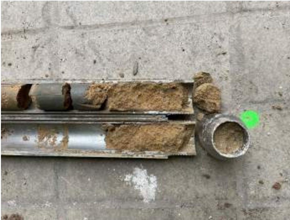
Fotografia nº 3. Sondeig S1. SPT a 4,4 m.
