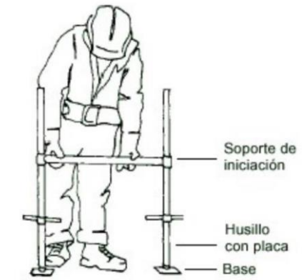
Figura 6. Introducción del soporte de iniciación en los husillos con placa
