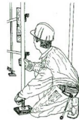
Figura 15. Comprobación de la nivelación vertical
