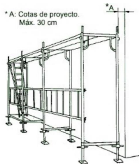
Figura 14. Encadenado del andamio y comprobación de la separación de la fachada
