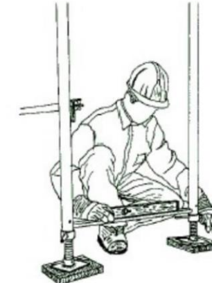
Figura 16. Comprobación de la nivelación horizontal
