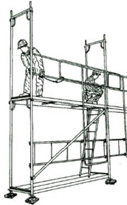
Figura 19. Montaje del resto del andamio
