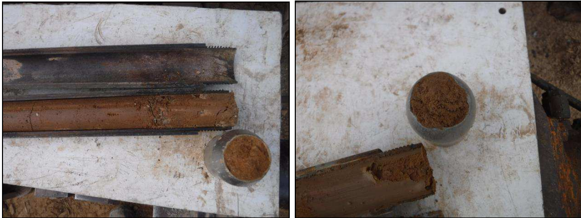
Assajos SPT realitzats a la capa A.
