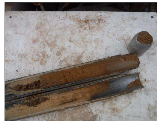
Foto 9: Sondeig S-3, SPT a 2,7 metres.
