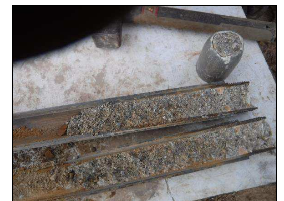
Foto 10: Sondeig S-3, SPT a 5,7 metres.
