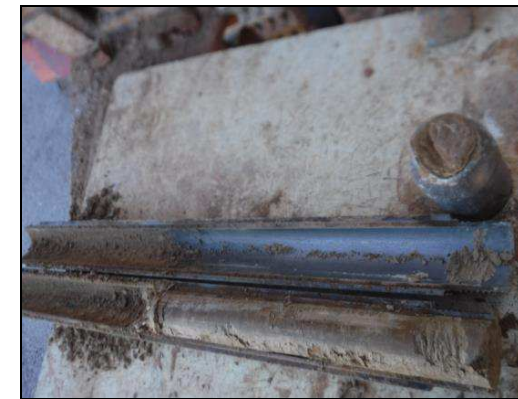
Foto 7: Sondeig S-2, SPT a 3,1 metres.
