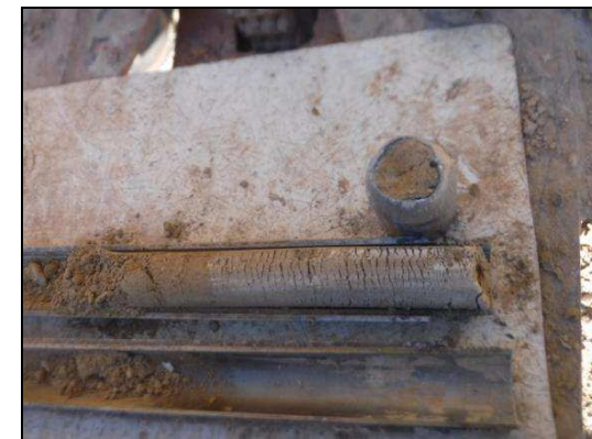
Foto 21: Sondeig S-7, SPT a 1,2 metres.
