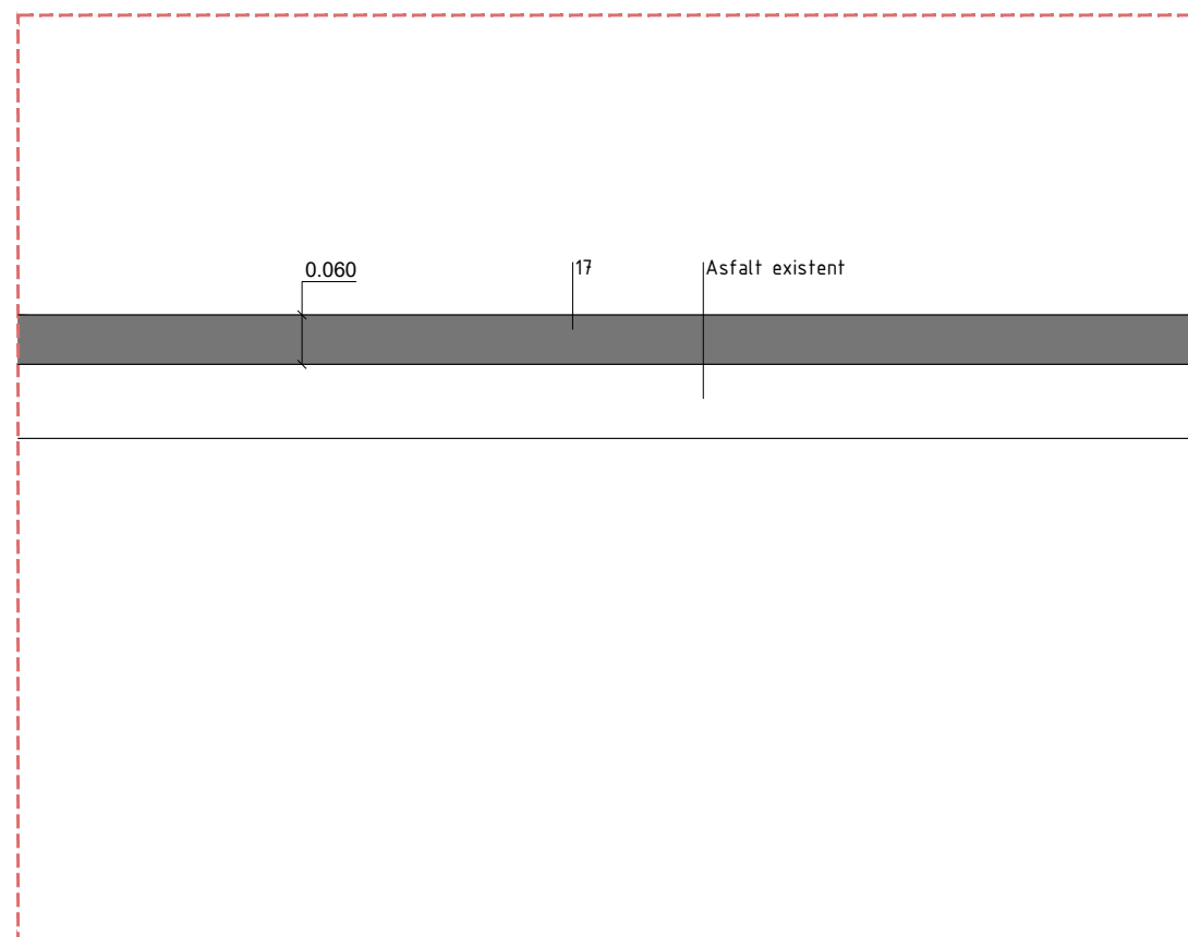
FRESSAT I CAPA RODADURA
