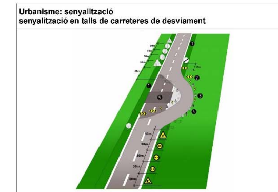
senyalització en talls de carreteres de desviament 1. voravia 2. tanca direccional 2x1m. 3. cone de balisament reflectants 4. senyal lluminosa 5. obres
