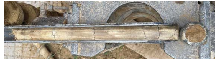
Detall de la mostra tipus SPT recuperada a 4,5m de profunditat del S2
