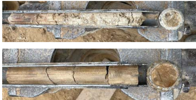
Fotografies dels assaigs SPT recuperats al primer sondeig
