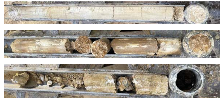
Fotografia nº 2. Sondeig S1. SPT's a -1,5m, 4,5m i -7,5m.
