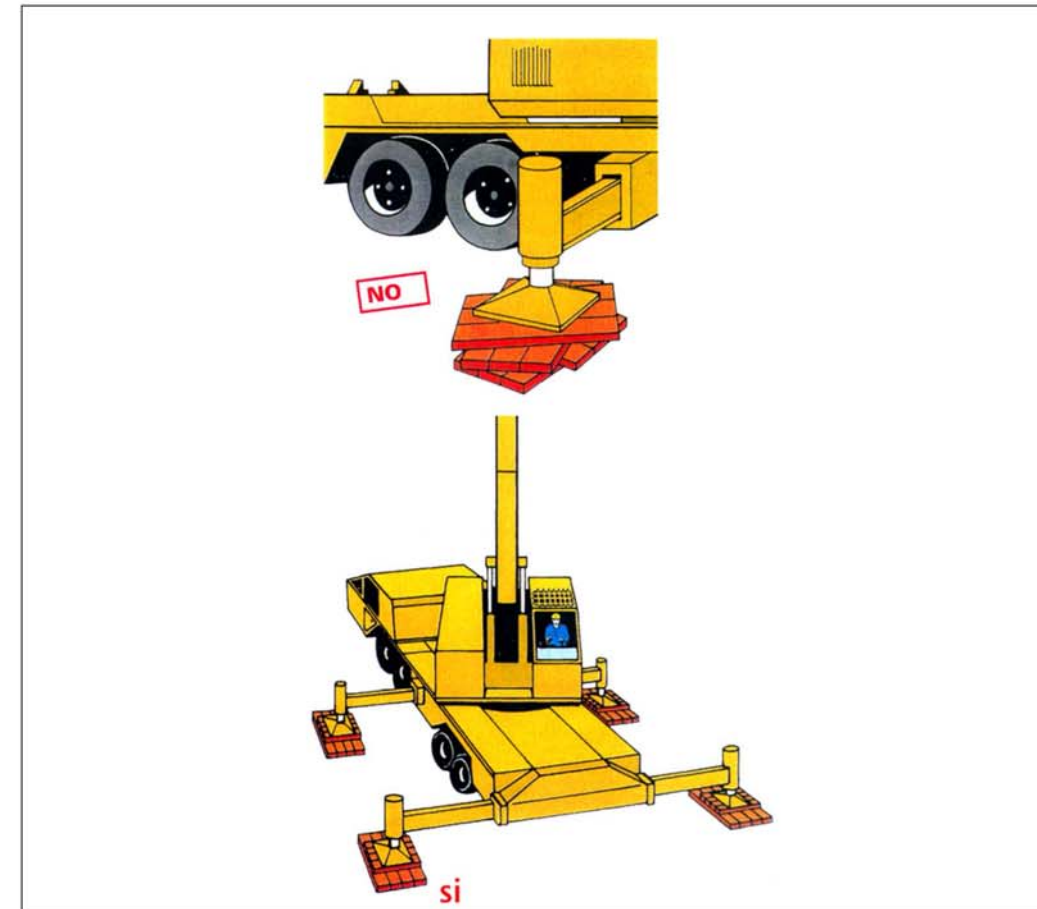
Col·locació estabilitzadors recolçaments
