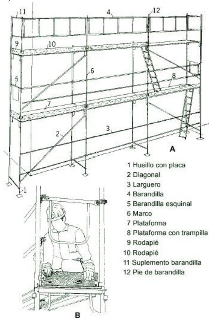
Figura 22. A: Coronación del andamio e instalación de elementos colectivos de seguridad. B: Instalación de rodapiés laterales
