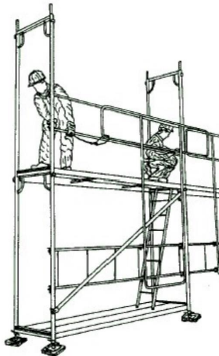
Figura 19. Montaje del resto del andamio
