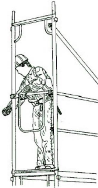
Figura 21. Colocación de barandillas esquinales
