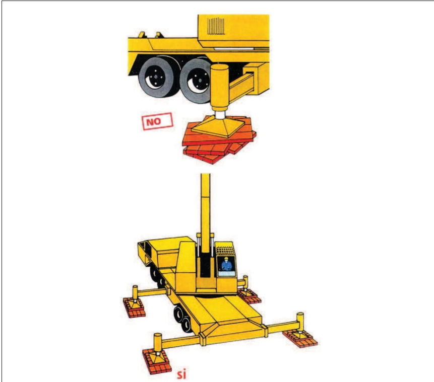
Col·locació estabilitzadors recolçaments
