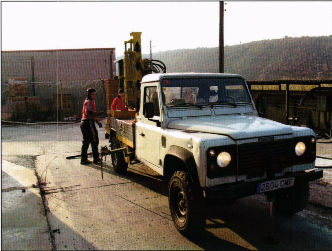
Fotografia 1. Equip utilitzat per a la investigació del subsòl en les antigues instal·lacions de Europrofil Aluminios S.A. emplaçat en el sondeig S-2.
