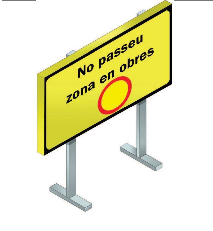
Senyalització obres: Precaució, zona en obres
