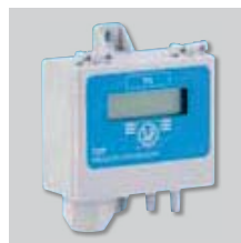
TDP-S/TDP-D/TDP-PI Transmisores de presión. Se utilizan para controlar la presión en sistemas de ventilación en presión constante. Permiten la lectura de la diferencia de presiones entre dos puntos y la transforman en una señal eléctrica apta para los diferentes equipos de control.
