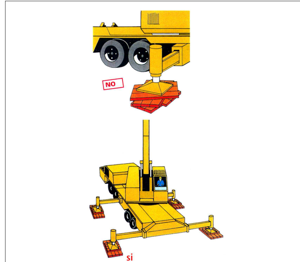
Col·locació estabilitzadors recolçaments
