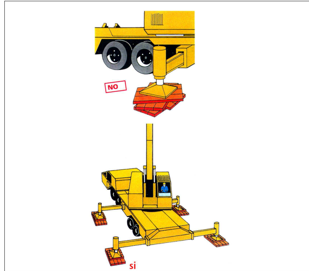
Col·locació estabilitzadors recolçaments
