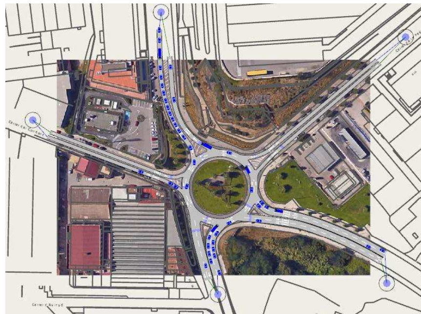
Figura 29. Imatge de la micro-simulació de l'escenari 0 rotonda BP-1503
