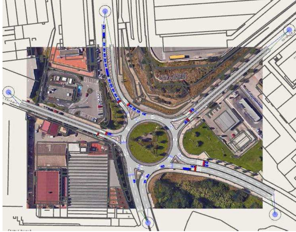
Figura 31. Imatge de la micro-simulació de la hipòtesi 1 fase Vermell de la rotonda BP-1503
