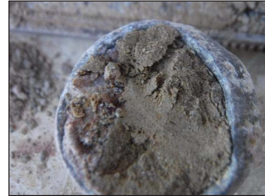
Foto 19: Sondeig S-6, SPT a 6,8 metres.
