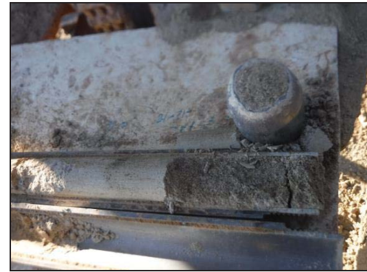
Foto 2: Sondeig S-1, SPT a 1,5 metres.
