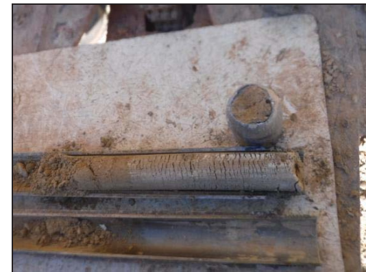
Foto 21: Sondeig S-7, SPT a 1,2 metres.
