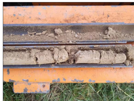
Foto 18: Sondeig S-6, SPT a 1,6 metres.
