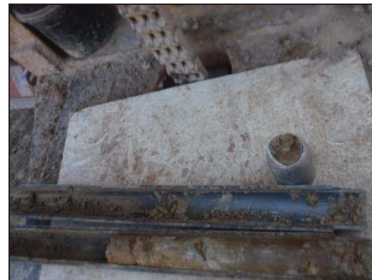
Foto 16: Sondeig S-5, SPT a 6,8 metres.
