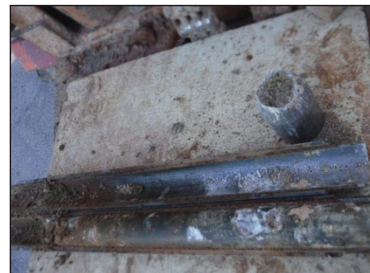
Foto 6: Sondeig S-2, SPT a 0,8 metres.
