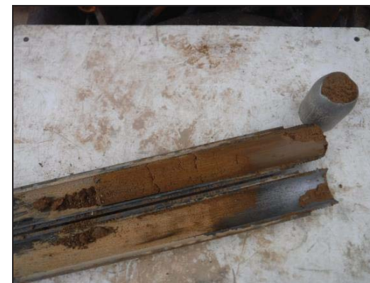
Foto 9: Sondeig S-3, SPT a 2,7 metres.
