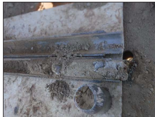
Foto 3: Sondeig S-1, SPT a 4 metres.
