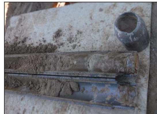
Foto 4: Sondeig S-1, SPT a 6,7 metres.
