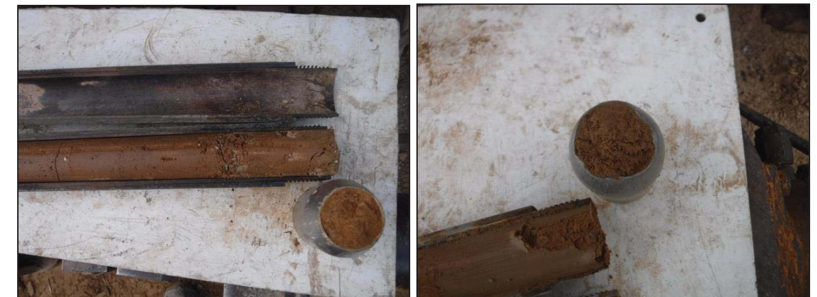
Assajos SPT realitzats a la capa A.
