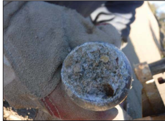
Foto 13: Sondeig S-4, SPT a 7 metres.
