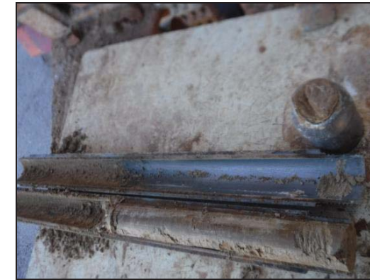
Foto 7: Sondeig S-2, SPT a 3,1 metres.
