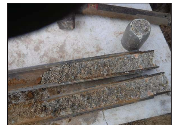
Foto 10: Sondeig S-3, SPT a 5,7 metres.
