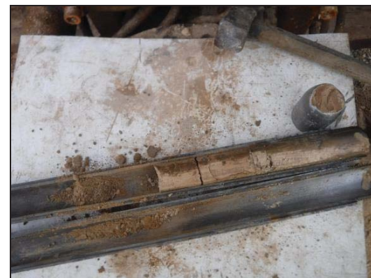
Foto 28: Sondeig S-9, SPT a 5,4 metres.
