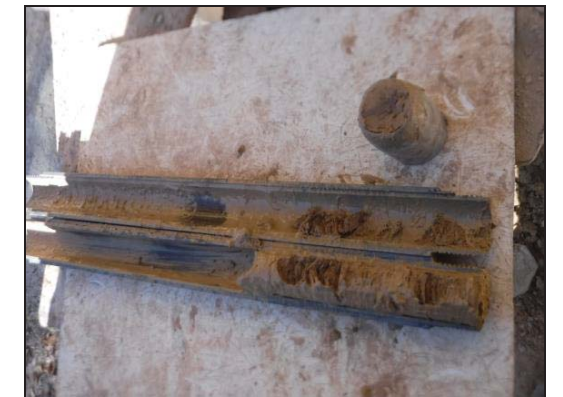
Foto 22: Sondeig S-7, SPT a 5,6 metres.
