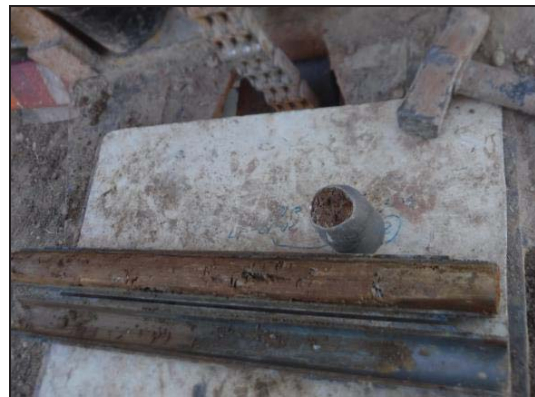
Foto 15: Sondeig S-5, SPT a 2,3 metres.
