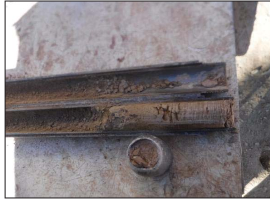
Foto 25: Sondeig S-8, SPT a 5,2 metres.
