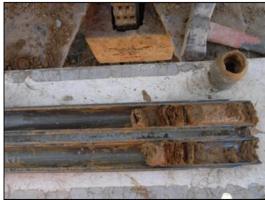
Foto 21: Sondeig S-7. SPT a 5,7 metres.
