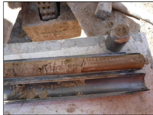
Foto 24: Sondeig S-9. SPT a 2,5 metres.
