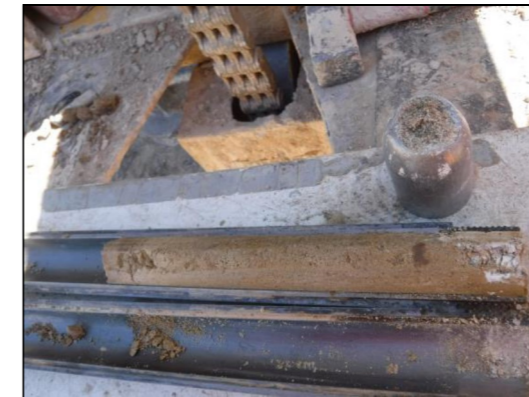
Foto 15: Sondeig S-5, SPT a 1,5 metres.
