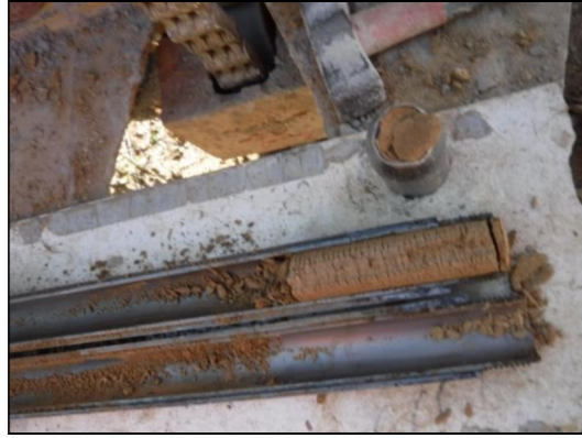
Foto 19: Sondeig S-7. SPT a 1,5 metres.
