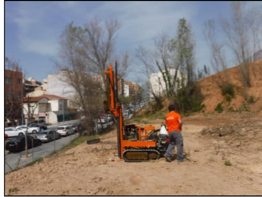
Foto 31: Assaig penetromètric P-8.
