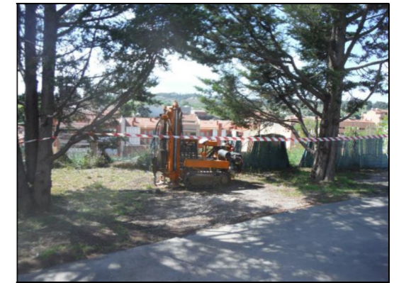
Foto 28: Assaig penetromètric P-2.
