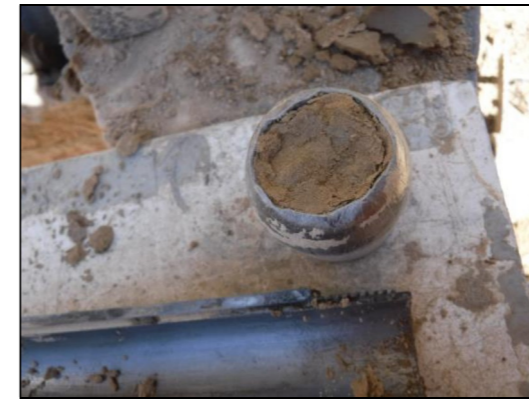
Foto 27: Sondeig S-9, boca SPT a 8,6 metres.
