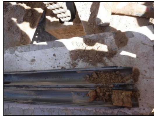
Foto 22: Sondeig S-7. SPT a 10,2 metres.
