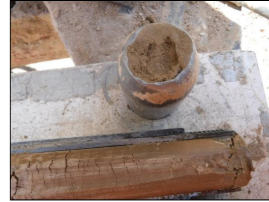
Foto 25: Sondeig S-9, boca SPT a 2,9 metres.
