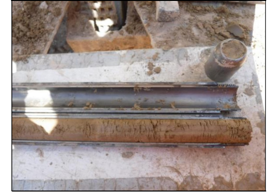
Foto 26: Sondeig S-9. SPT a 8,3 metres.
