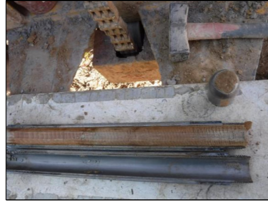
Foto 20: Sondeig S-7. SPT a 2,6 metres.
