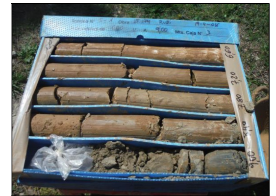
Foto 4: Sondeig S-1, caixa de 6 a 9 metres.
